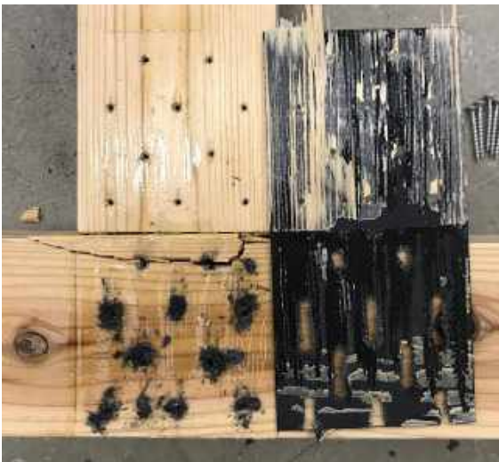
図-9 CFRP プレート固定部上端の破壊(XG0.75P-3)
