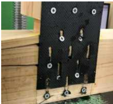
図-7 ビスのパンチングアウトと CFRP プレート端部からの引き抜き、土台の破壊を伴った試験体(XG0.75P-2)
