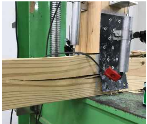
図-10 土台中央部の割裂破壊(EP0.5P-1)
