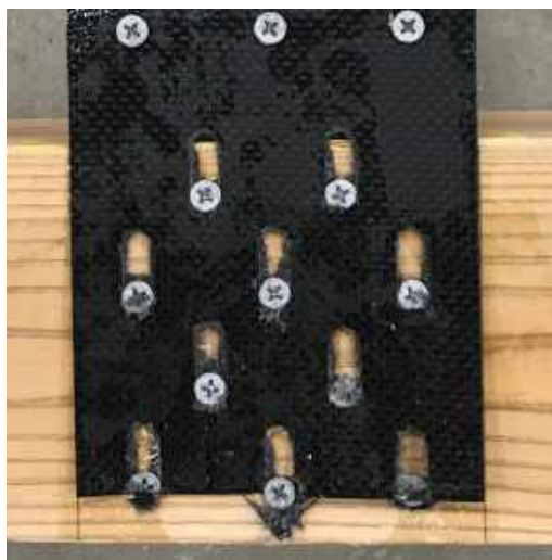
図-12 ビスのめり込みによる CFRP プレートの変形(XG0.5P-1)
